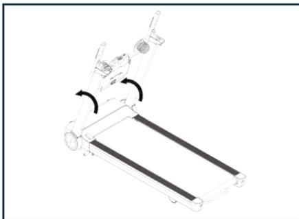
Relevez les montants à partir des barres d'appui jusqu'à entendre un déclic, pour verrouillez les montants.
