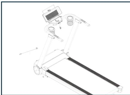
Branchez le câble d'alimentation sur l'avant du tapis. Branchez l'autre extrémité du câble sur une prise de courant.
