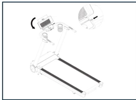
Appuyez longuement sur le levier de réglage de la tablette et repliez le support pour tablette jusqu'à ce qu'il soit aligné sur les barres d'appui.
