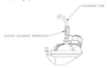
Fig. 6 – Discharge Thermistor (ODT)
